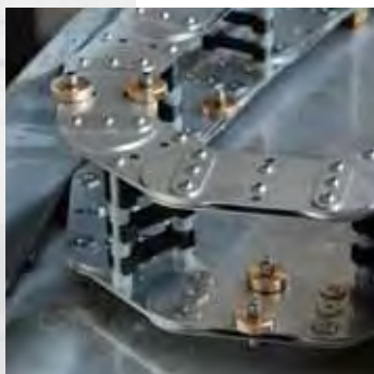
LZ94 típusú energilánc: körbeforgó alkalmazás robbanásbiztos ATEX Zóna 2 előírásnak megfelelő kivitelben
